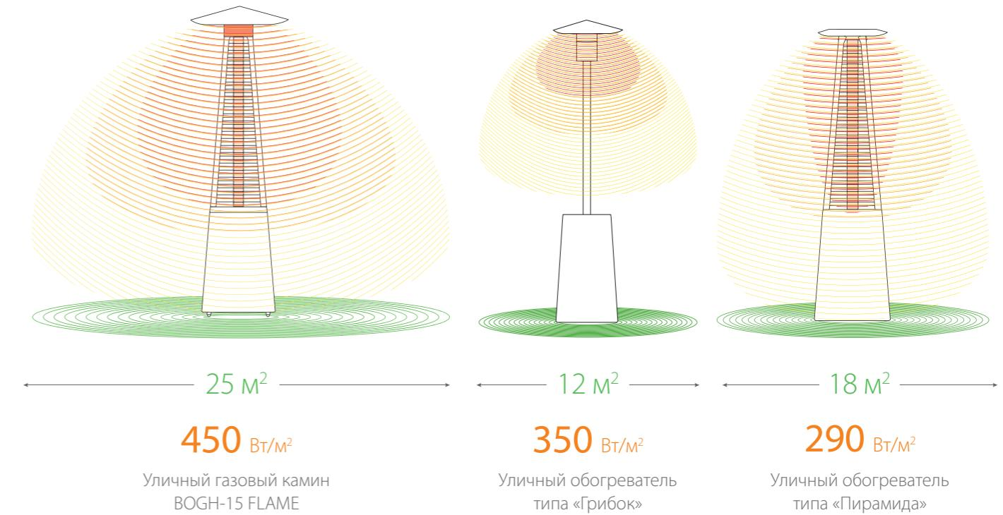
Ключевой показатель, характеризующий эффективность уличного ИК-обогревателя — плотность теплового потока (Вт/м<sup>2</sup>). Он показывает, сколько тепла может отдать прибор на определенную площадь\*.
